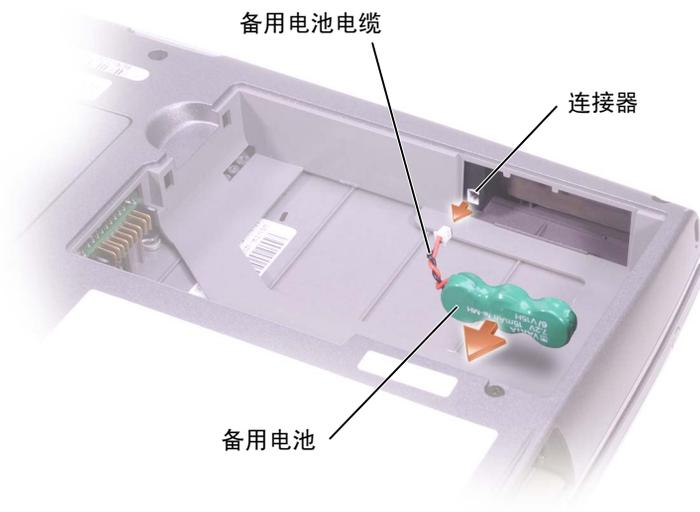
**4** 将备用电池电缆连接至备用电池盒中的连接器。
