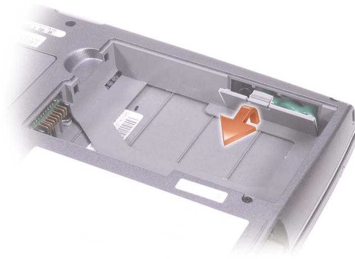
**3** 从电池盒中取出备用电池，然后从连接器中断开电缆的连接。
